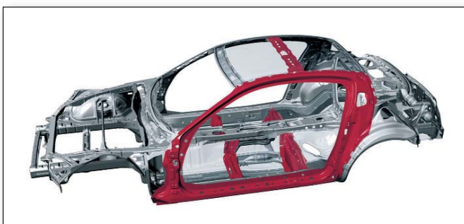
Chasis de acero y aluminio de un automóvil.
