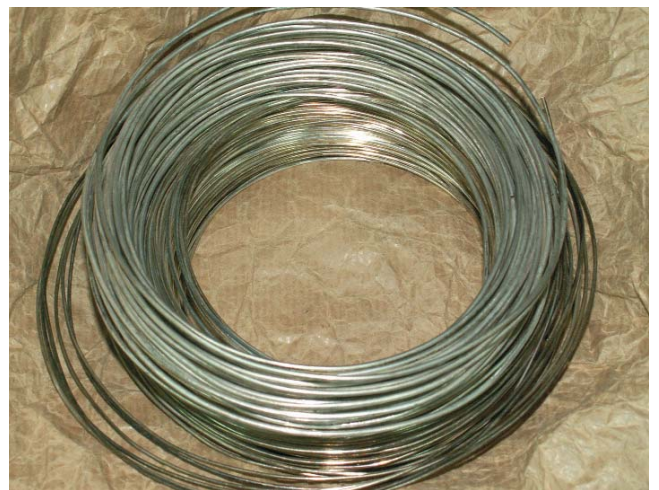
Hilo de cobre galvanizado fabricado aprovechando la alta ductilidad del cobre.
